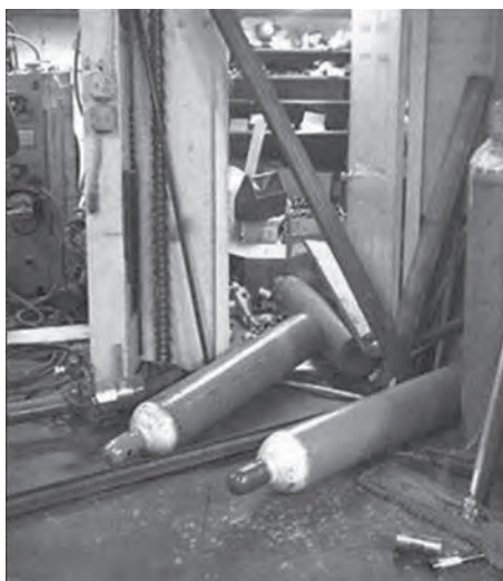
واژگونی سیلندرهای گاز در اثر زلزله
